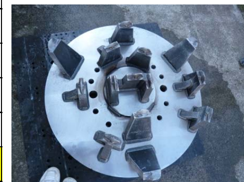
写真.ディスクカッタ(全断面型)
