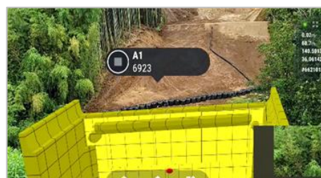
構造物 (橋台) 3D 設計データ画像
